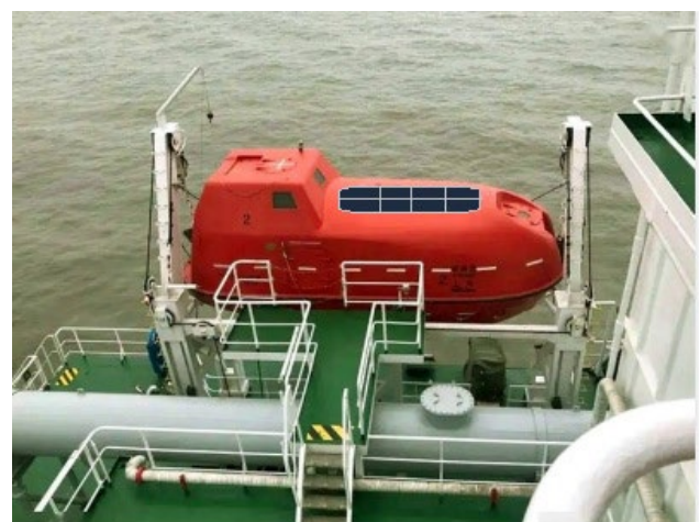
Рис. 4. Зовнішній вигляд рятувальної шлюпки дообладнаної сонячною панеллю
